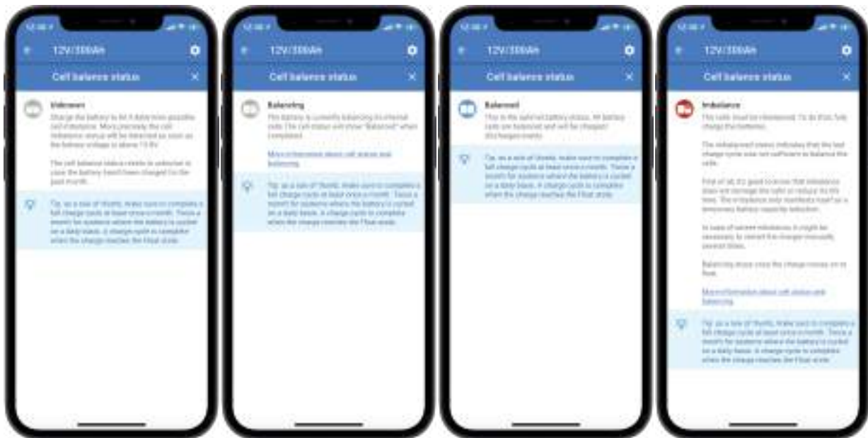
Information relative à l'équilibrage des cellules. De gauche à droite : Inconnu, Équilibrage en cours, Équilibré et Déséquilibré.
