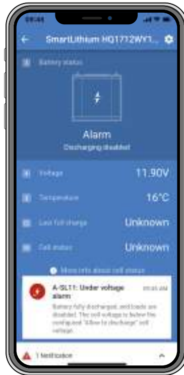
Alarme de sous-tension
